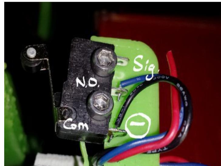
Illustration 2: Soudure deux fils sur endstop direct
