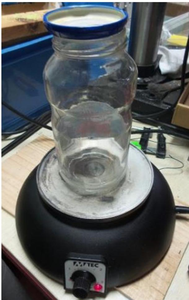
4°) Mettre le bocal sur une plaque chauffante (régulée en température).
