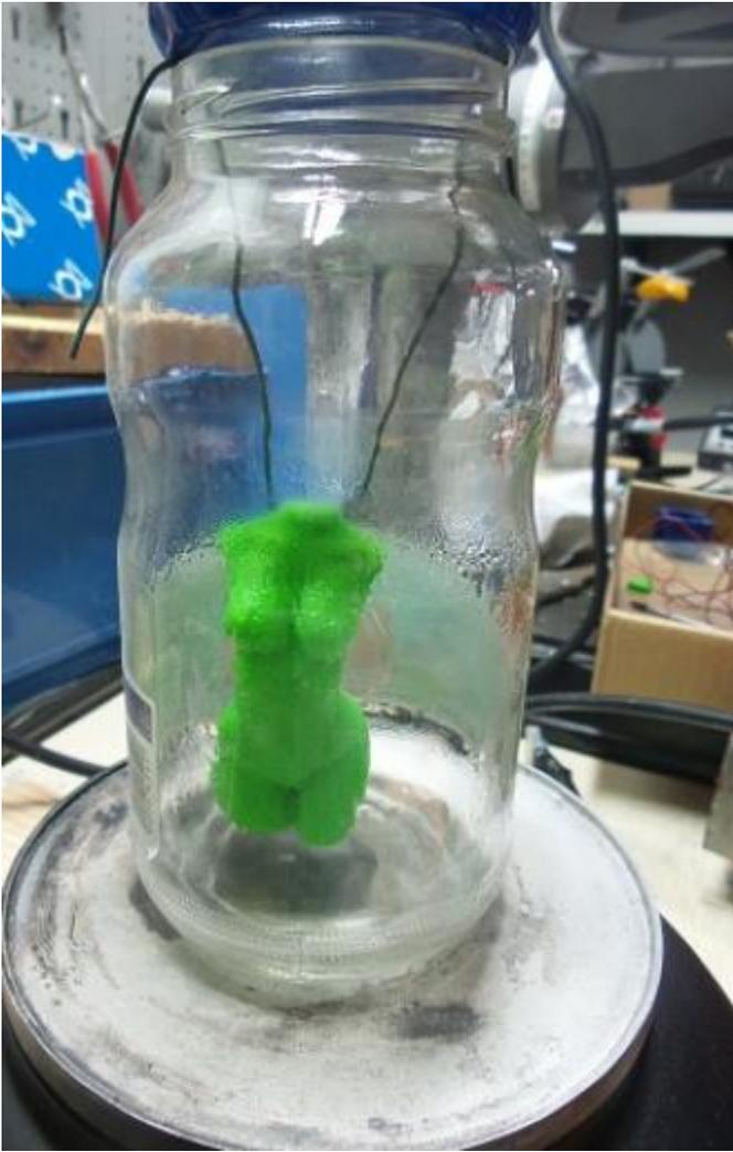
3°) Dans le bocal mettre 3 à 4 mm d'Acétone.28/6/2014 Team-Usinage • Afficher le sujet - Lissage ABS avec vapeur d'Acétone
