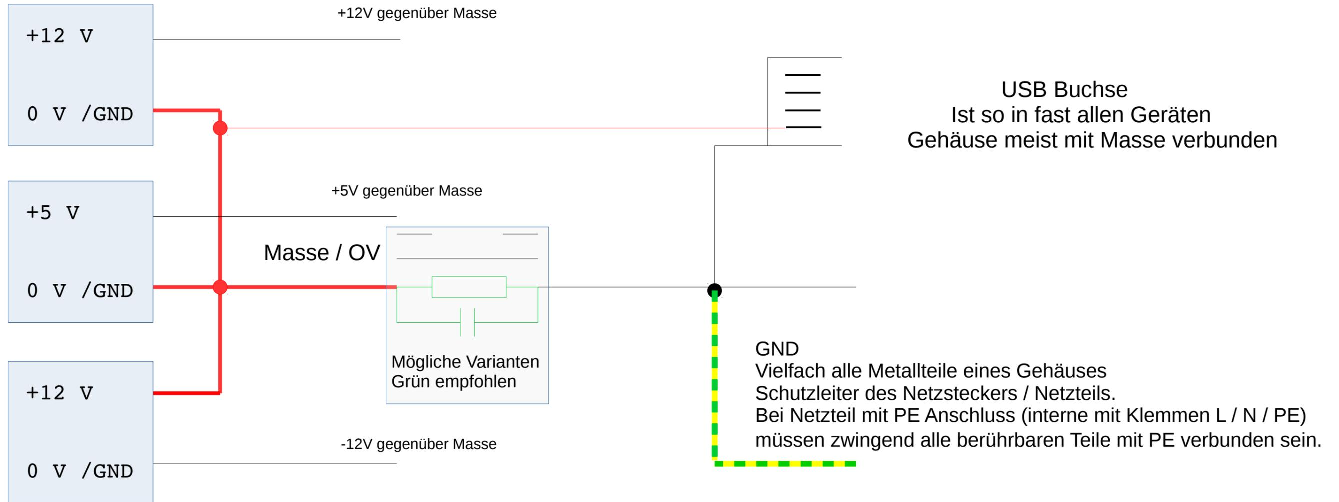
Zusammenschaltung von 2/3 und mehr Spannungsquellen
