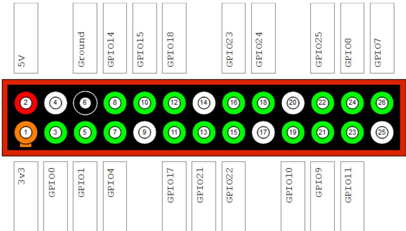
Es gibt hier 8 als Ein/Ausgang programmierbare Pins, und die I2C,SPI und UART Pins. Die Ansteuerung der Pins erfolgt am einfachsten mittels der Programmiersprache Python. Dazu ist die Installation einer Bibliothek notwendig, da diese nicht in der Debian Distribution vorhanden ist.
