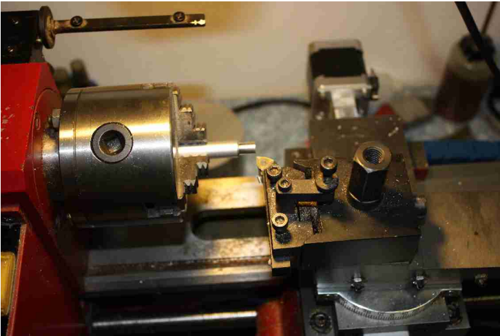
Abbildung 5: Erster automatischgedreht der Wellenansatz
