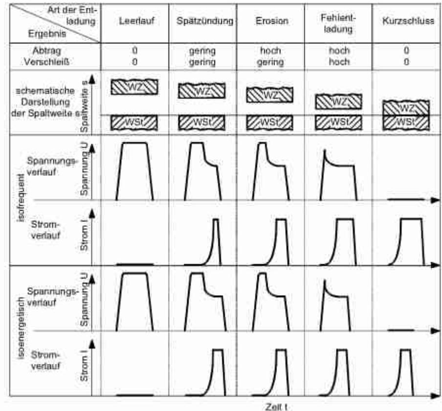
Abb. 2.7. Darstellung unterschiedlicher Entladungen mit ihren Auswirkungen auf Abtrag und Verschleiß
