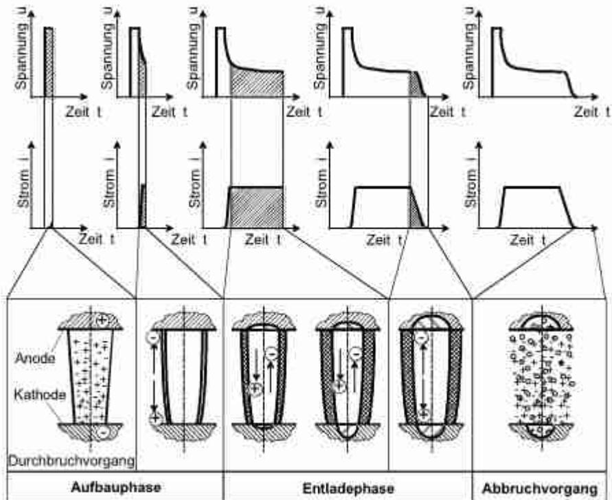
Abb. 2.2. Funkenerosives Senken - Darstellung der Phasen einer Funkenentladung
